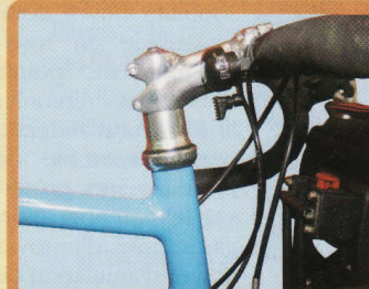
← Les liaisons de la potence avec le cintre et la fourche.
