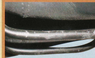
← Chariot de selle avec graduations. Pratique pour relever le bon réglage.
